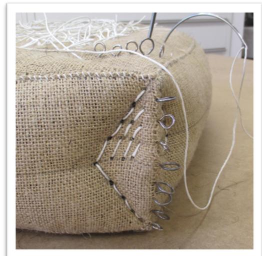
Nach dem Bearbeiten der Ecken werden die Kanten garniert.
