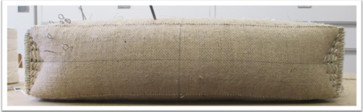
Dies geschieht ebenfalls immer parallel auf Ober- und Unterseite. Bei quadratischen Carreaus werden die Seiten immer einzeln garniert, niemals in einem Stück ringsum, da sonst das Carreau verzogen wird und die fertige Ausformung nicht sauber ist. Gerade Strecken werden also immer zweifach gespiegelt bearbeitet, und zwar jeweils Ober- und Unterseite sowie die sich gegenüberliegenden Seiten.
