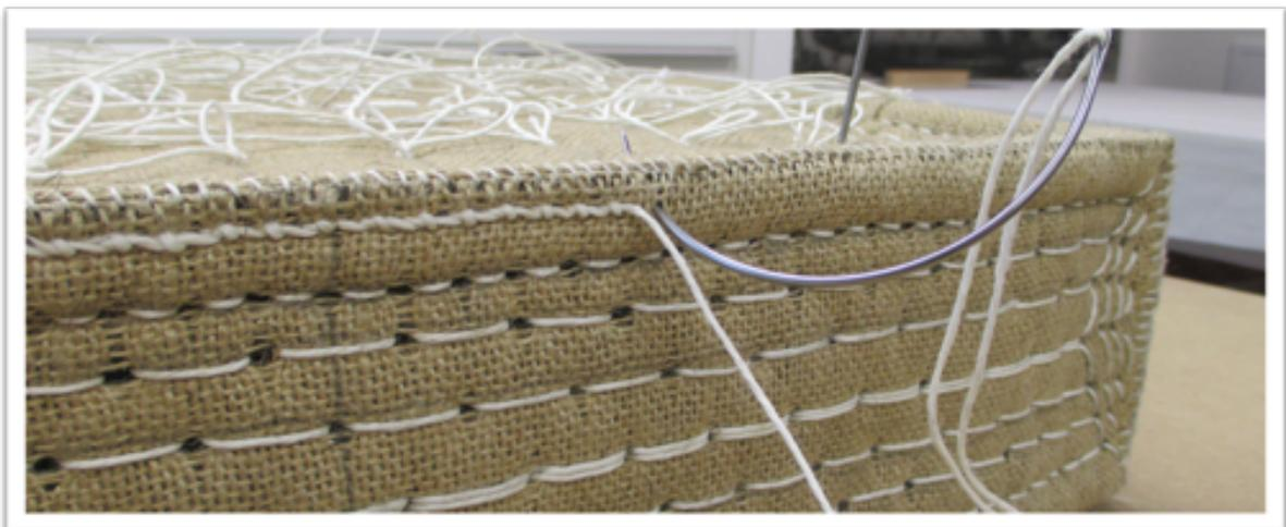
Der Schweinerippen-Stich kann ringsherum gearbeitet werden. Abschließend werden die Heftfäden auf die fertige Höhe gezogen und abgeknotet.
