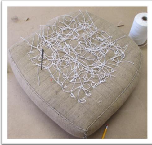
Ist alles geformt, können die Böden mit den Platten vernäht werden. Ein überwendlicher Stich bietet sich hier an, der in engen Abständen (ca. 2 Fäden zwischen den einzelnen Stichen) genäht wird.
