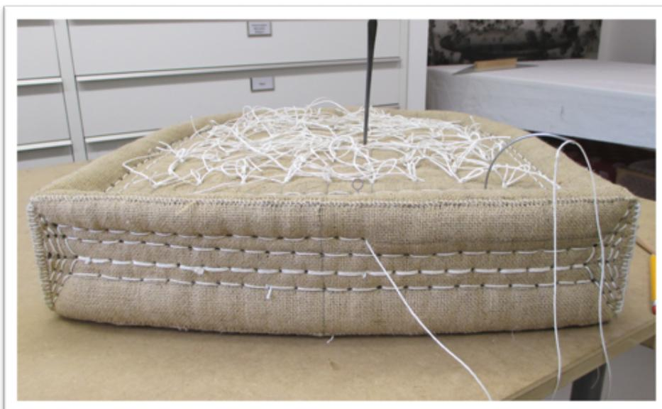
Jede Garnierreihe sollte angezeichnet werden. – ein Leiterstich ist hier ausgeschlossen, es wird mit Vorder- und Hinterstichen gearbeitet
