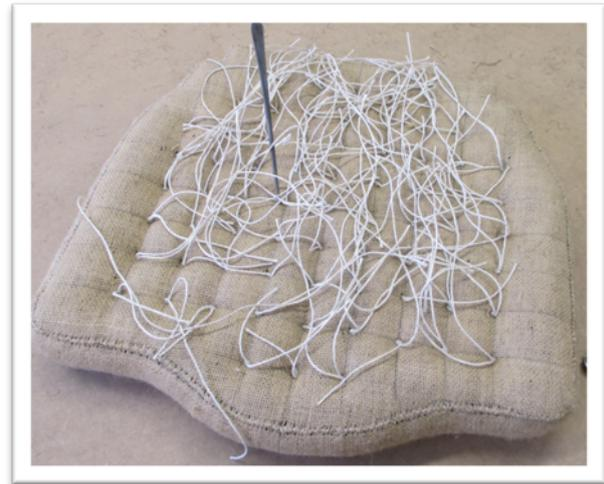
Falls es scharfe Ecken gibt, müssen diese vorher ausgarniert werden, und zwar immer in paralleler Weise auf der Ober- und Unterseite. Die Diagonalen Stiche der Eckgarnierung haben die Abstände der vorher überlegten Garnierung. Dies sollte mit Steckern markiert werden.
