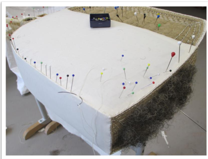
Die Pikierung sollte möglichst flach gehalten werden. Es bietet sich Rosshaar an. Aus französischen Fachbüchern geht hervor, dass die Pikierung auch aus Federn bestehen kann. Die aufgelegte Pikierung darf eine Höhendifferenz von allerhöchstens 1,5 cm zur Vorderkante haben. Auch der Boden muss pikiert werden, jedoch so dünn, dass kein Auftrag sichtbar und lediglich die
