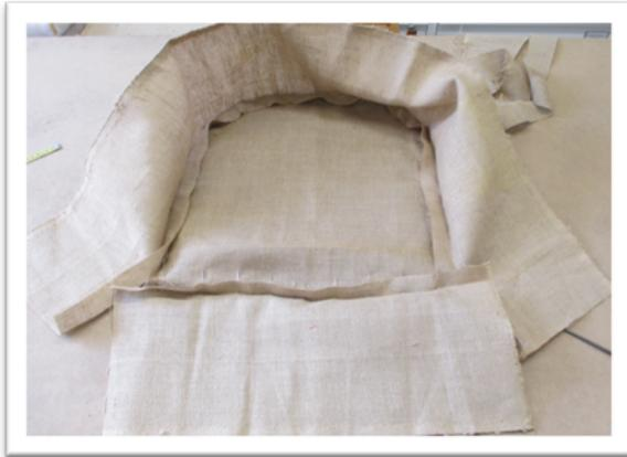
Die Böden werden nun mit der Unterplatte zusammengeheftet und anschließend das Material aufgelegt. Es empfiehlt sich Rosshaar, da die spätere Kantenbildung immer sauberer wird als mit pflanzlichen Fasern. Wenn das fertige Carreau Piqué eine gewisse Höhe überschreitet, kann man auch eine Art Kern aus pflanzlichen Fasern mit einarbeiten, da das Arbeiten mit einem so großen Berg Rosshaar unpraktisch ist.
