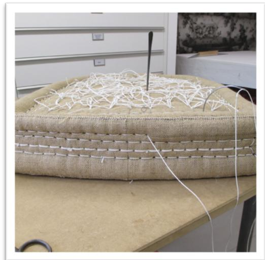
Der letzte oder – falls mit Schweinerippen-Stich gearbeitet wird – der vorletzte Stich, sollte immer verknotete sein, da er das Material für die fertige Kantenbildung nochmals gut komprimiert.
