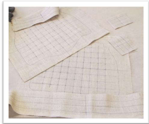
Nun werden die Böden angefertigt. Dazu wird die fertige Höhe auf der Leinwand aufgezeichnet sowie die vertikale Mitte durchgehend in der Fadengasse markiert.
